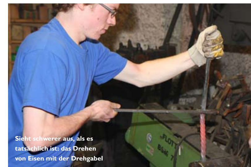
Bei 1100 Grad hat Eisen die Idealtemperatur zum Schmieden erreicht
